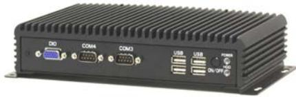
Der Industrie-PC ist ausschließlich zur festen Montage in der Maschinen- und Anlagentechnik für den gewöhnlichen, maschinennahen und industriellen Einsatz bestimmt.
