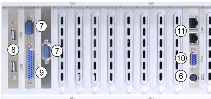
Rückansicht Version mit Slot-CPU und Backplane, Beispielkonfiguration
